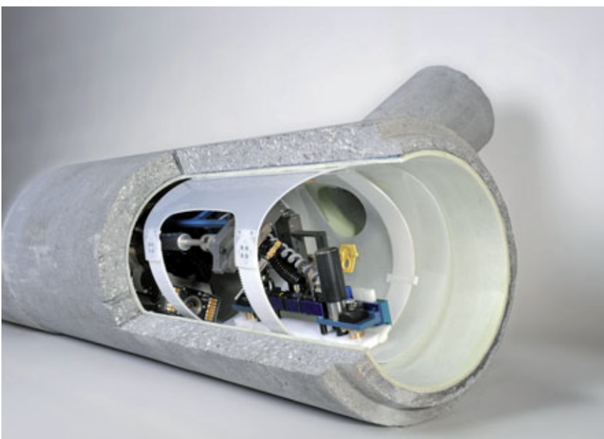
Abb. 2 KA-TE-Schalungssetzgerät mit der patentierten Schalungsmanschette, hier beim Ausschalen eines sanierten Zulaufes (Modell)
