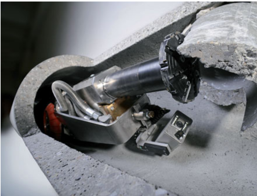
Abb. 5 Fräsroboter mit Aufbau für Frontalfräsen zum Entfernen von stark einragenden Hindernissen (Modell)
